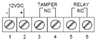
контакт 1 , отмеченный минусом -12V / GND- подсоединить к отрицательному выходу источника постоянного тока 9V - 16V на контрольной панели.
