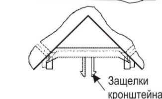
**6б** Установить основание на кронштейн, вставив защелки кронштейна в паз основания извещателя.
