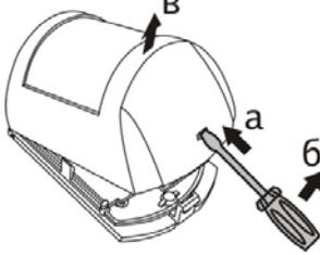
**2** Отогнуть зацепы на основании. Снять плату
