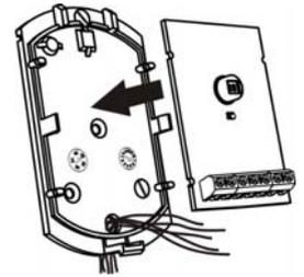
**8** Закрепить подведенные провода в клеммах извещателя.
