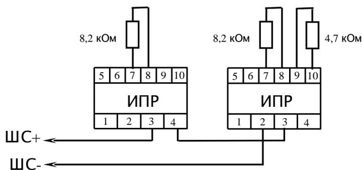
**Схема подключения извещателей "Фотон-СК", тип шлейфа5**
