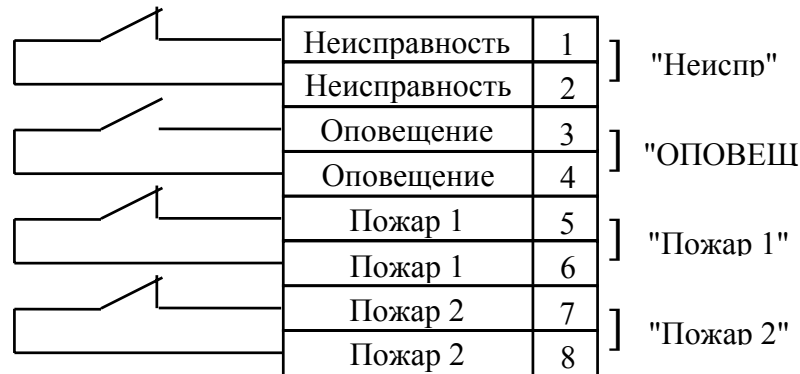
Рисунок 10 - Схема подключения контактов реле прибора ППК-2М к коммутационным колодкам
