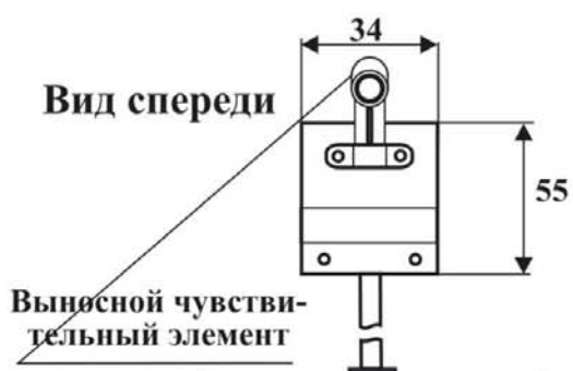
Рис 3 Извещатель пожарный пламени "Пульсар 1-010Н" со снятой розеткой
