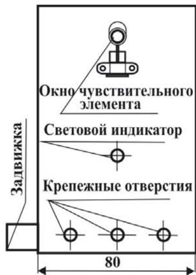
Рис 3 Извещатель пожарный пламени "Пульсар 1-010Н" со снятой розеткой
