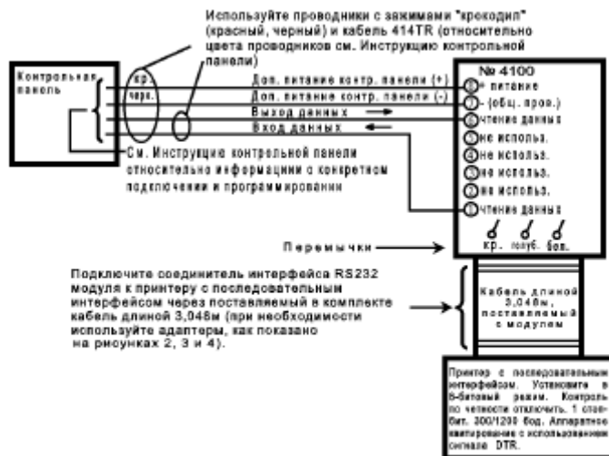
Рисунок 5 – Соединения для регистрации событий (принтер с последовательным интерфейсом под управлением модуля)
