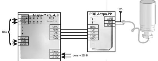
Передатчик системы Астра-РИ, используемый в автономном режиме для передачи информации о состоянии ШС упрощенной проводной ОС/ПС на удаленный пост
