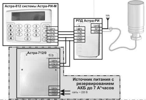
Передающая часть системы Астра-РИ, для передачи информации о состоянии ППКОП Астра-712/4 проводной ОПС объекта на удаленный пост охраны
