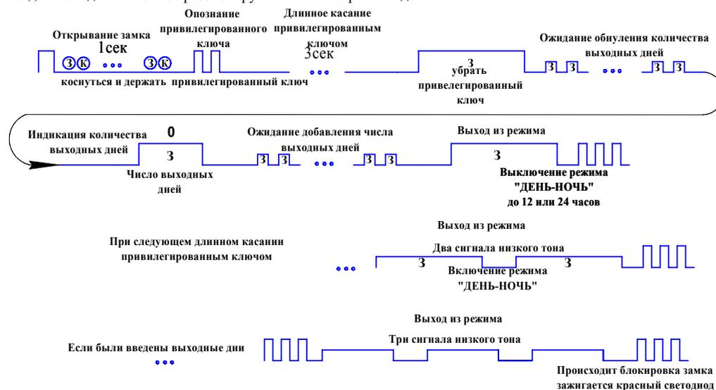
С помощью длинного касания привилегированным ключом можно временно отключать и включать режим "день-ночь" . Если после первого длинного касания привилегированным ключом не вводить выходные дни, то при выходе из режима произойдет автоматическое отключение режима "день-ночь" до ближайших 12 или 24 часов, после чего режим "день-ночь" опять включится автоматически.
