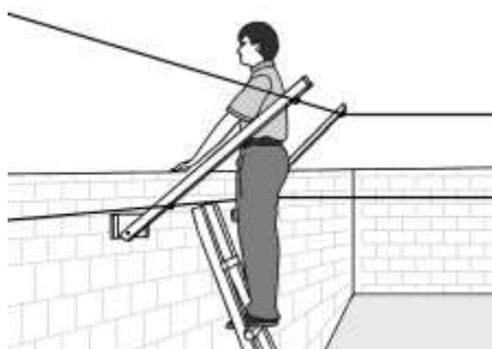
Рисунок 2.9. Способ имитации преодоления ЗО при козырьковом варианте установки.
