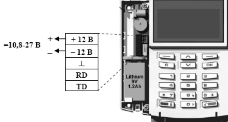
В случае необходимости стационарного подключения пульта к радиорасширителю РРОП по интерфейсу RS-232 используйте четыре проводника.
