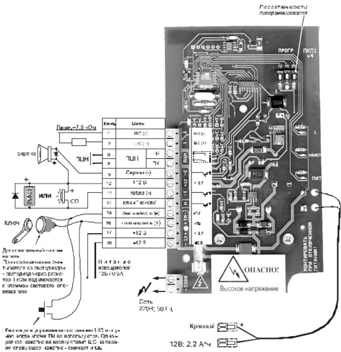
Рис 2. Схема внешних соединений прибора "Гранд МАГИСТР 1А"
