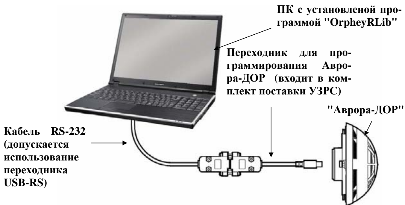
Рисунок В.24 – Подключение ПК для программирования речевых сообщений в устройство "Аврора-ДОР"
