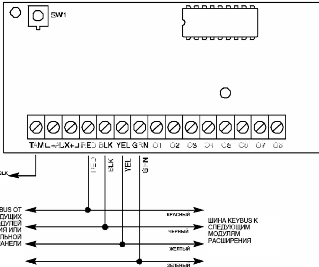
Пример подключения управляемого устройства к выходу:
