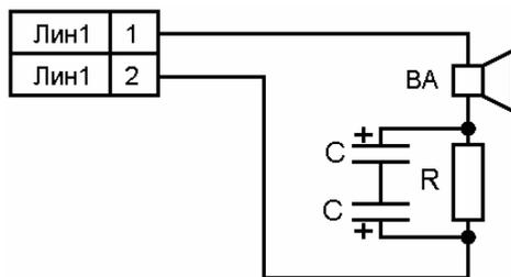
Рис. 2 Схема электрическая «АС-2-1»
