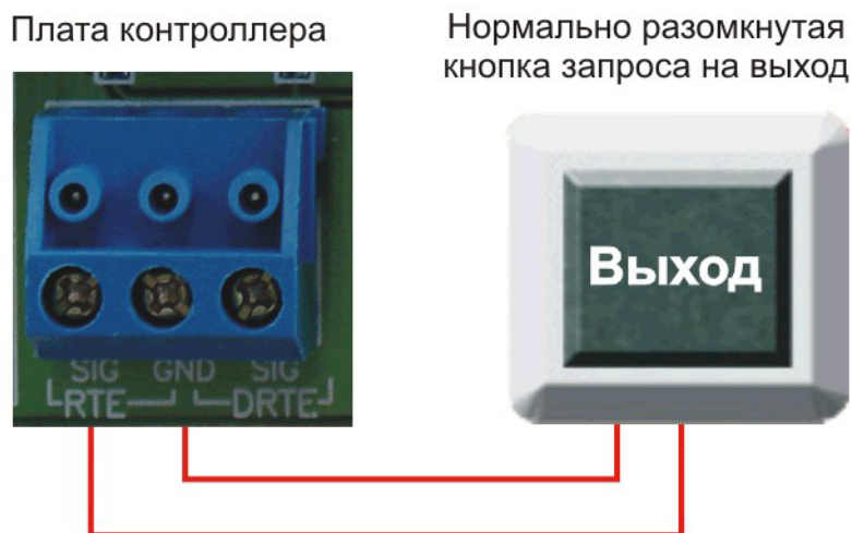
Рисунок 9. Схема подключения кнопки запроса на выход.
