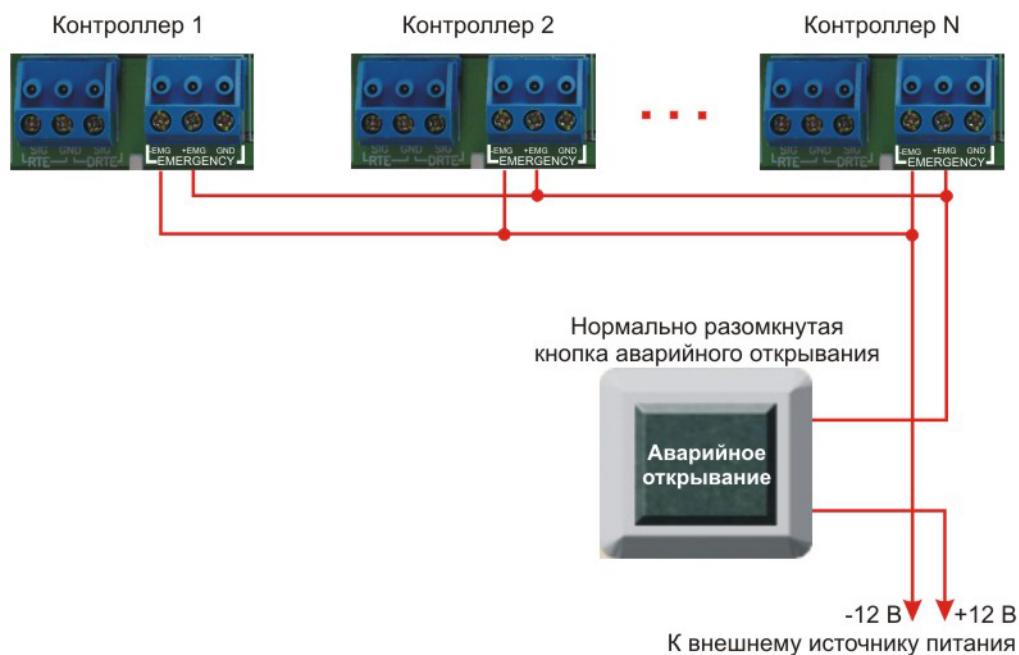
Рисунок 22. Подключение одной кнопки к нескольким контроллерам.
