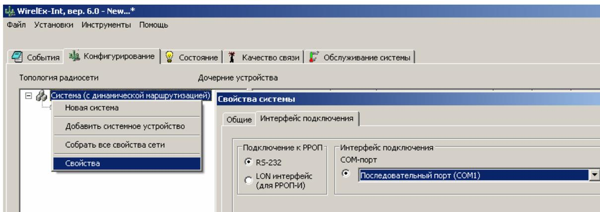
Возможно выбрать интерфейс RS-232 или интерфейс S2 (LON). Для программирования по интерфейсу S2 потребуется наличие блока сетевого интерфейса БПИ RS-И или одного из сетевых интерфейсов "Echelon" (USB U.10, Ethernet i.LON10 и проч.).
