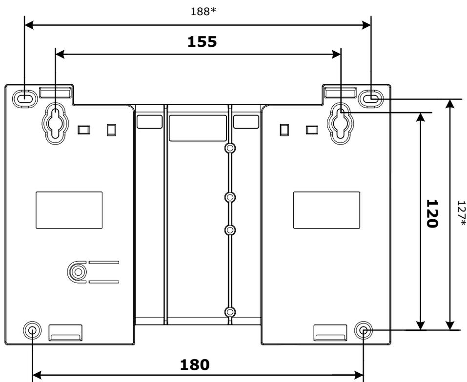
После навешивания РРОП-И он закрепляется на стене путём ввёртывания одного, либо двух дополнительных шурупов.
