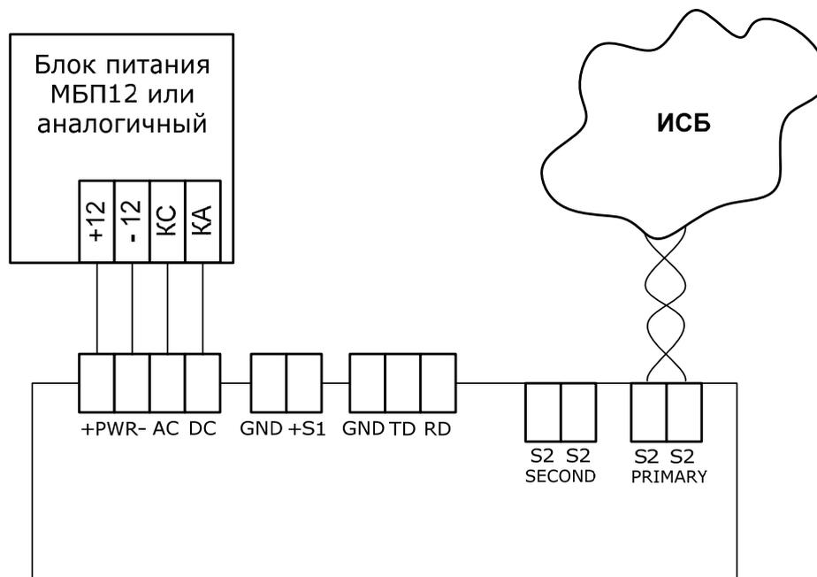
Рисунок 1 Подключение РРОП-И
