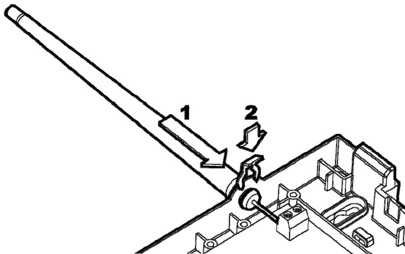
При необходимости вместо штатных антенн возможно подключение внешних антенн. Внешние антенны должны иметь волновой импеданс 50 Ом и подключаться к разъёмам посредством коаксиальных кабелей.
