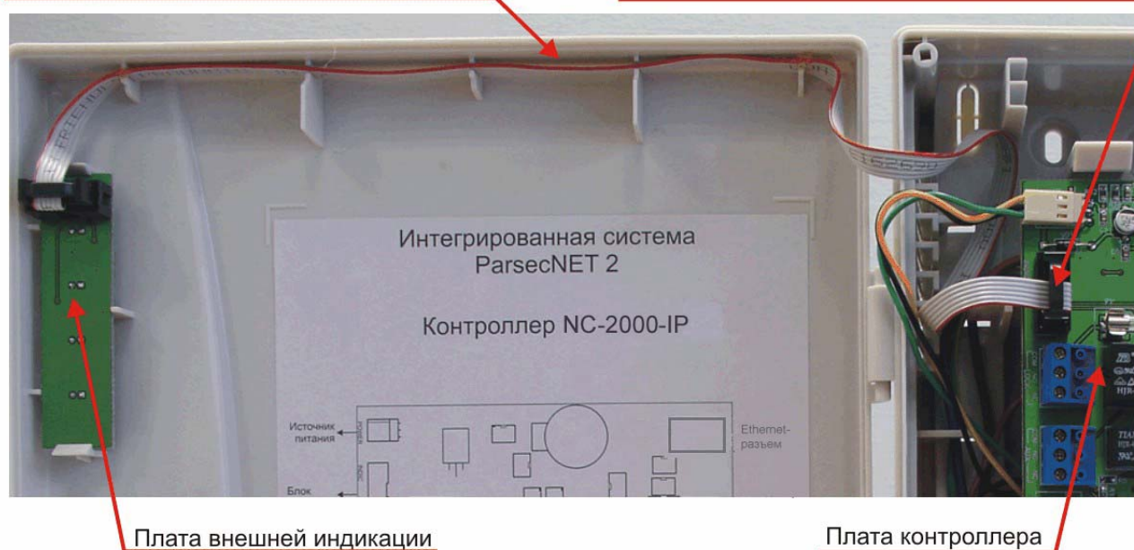
Рисунок 21. Схема подключения платы внешней индикации.
