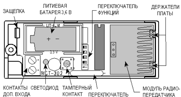
Рисунок 1. МСТ-302/МСТ-302S со снятой крышкой
