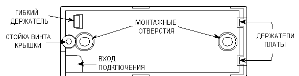
Рисунок 5. Основание со снятой печатной платой
