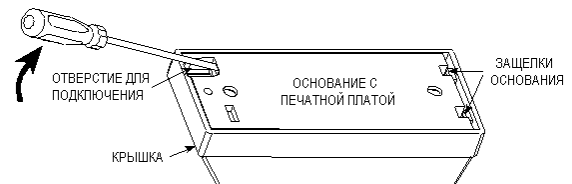
Рисунок 4. Снятие крышки с основания
