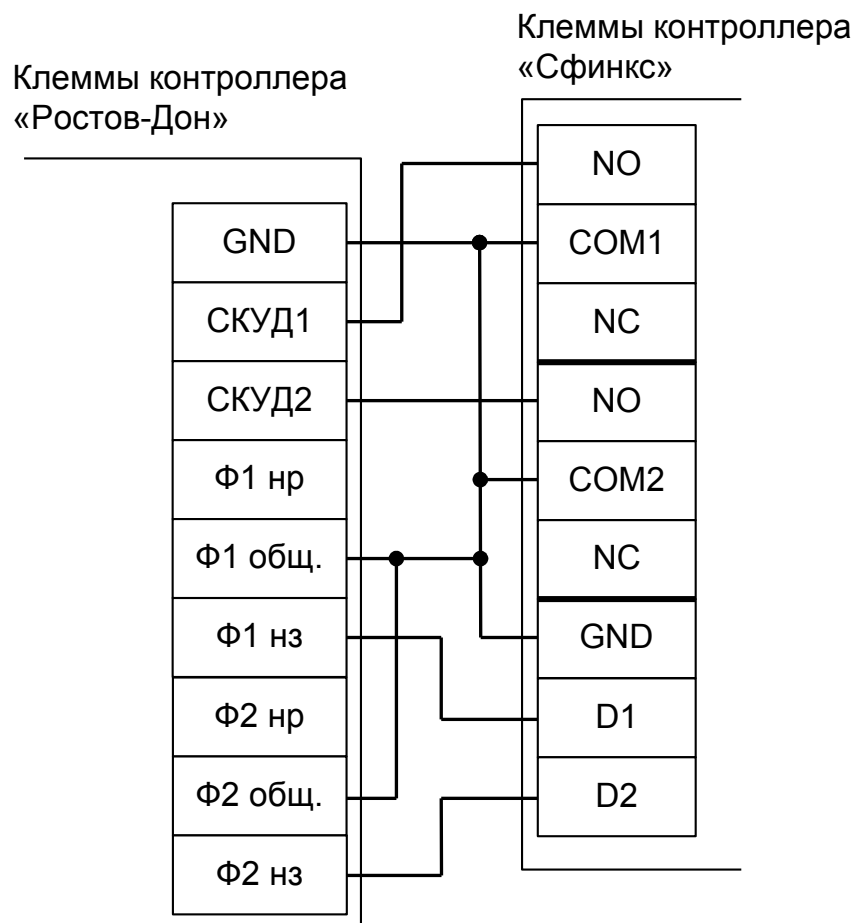
Рисунок 70. Подключение турникетов и калиток «Ростов–Дон», новая электроника, вариант №2.
