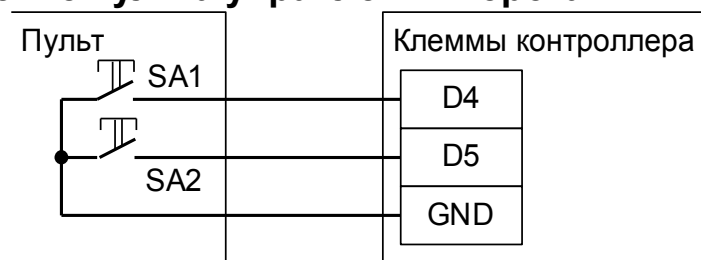
Рисунок 100. Подключение пульта ручного управления воротами, вариант №1.
