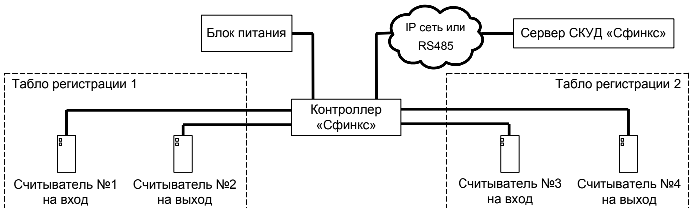
Рисунок 16. Вариант подключения в конфигурации «Терминал учёта рабочего времени».
