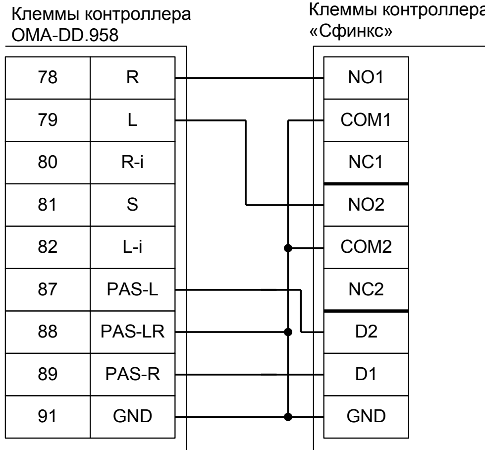
Рисунок 59. Подключение турникета ОМА с контроллером ОМА-DD.958, ОМА 264МС1.
