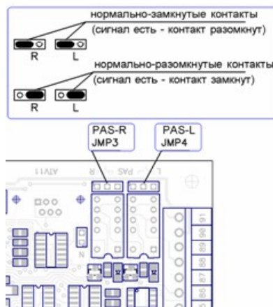
Рисунок 60. Перемычки JMP3 и JMP4 контроллера ОМА-DD.958, ОМА 264МС1.
