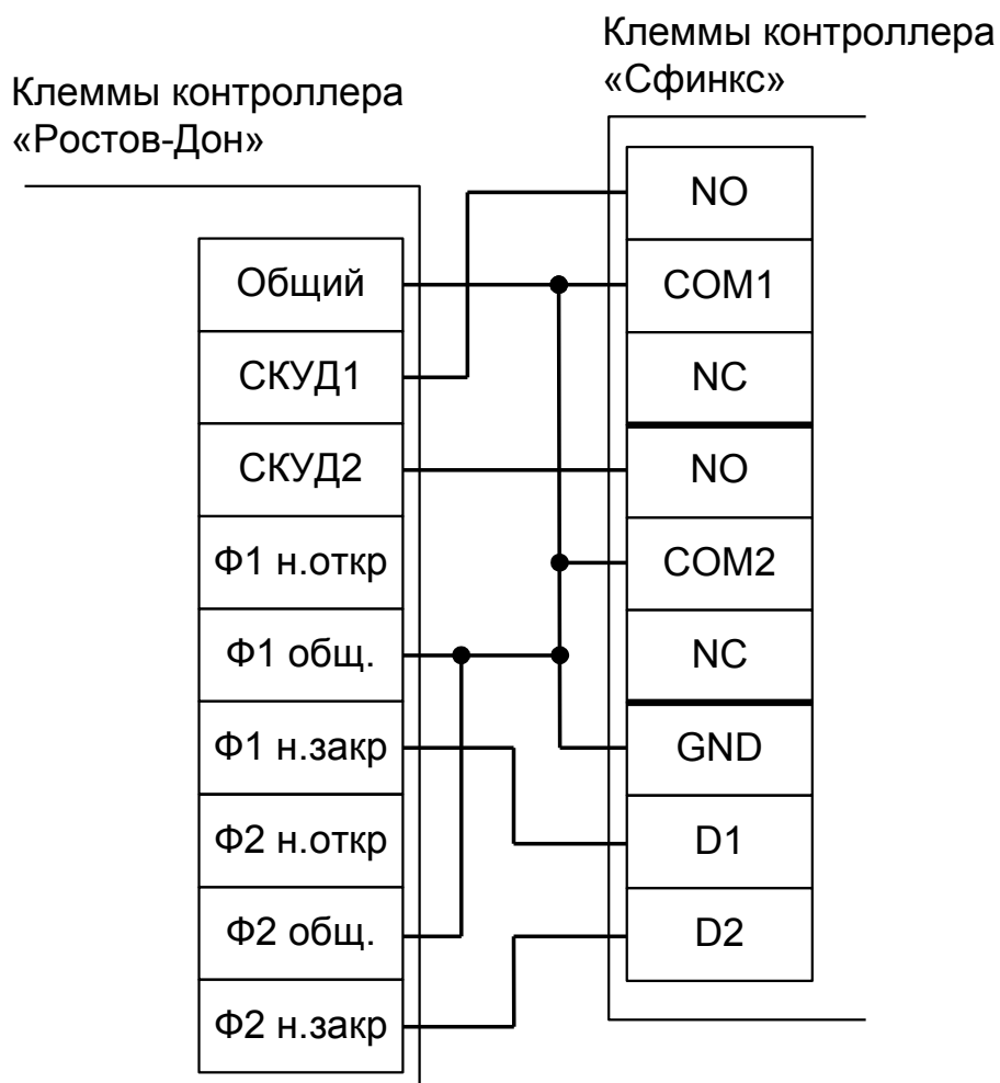
Рисунок 69. Подключение турникетов и калиток «Ростов–Дон», новая электроника, вариант №1.
