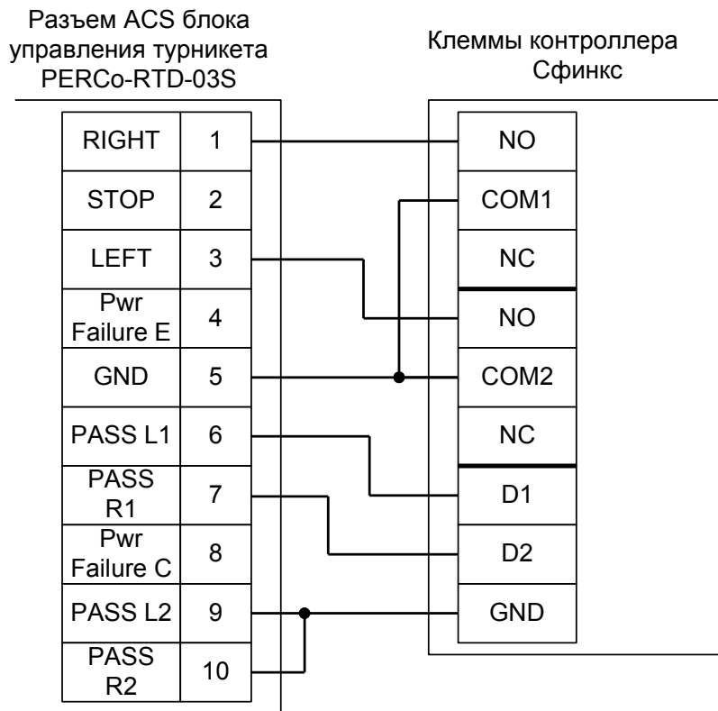
Рисунок 47. Подключение турникета PERCo-RTD-03S.
