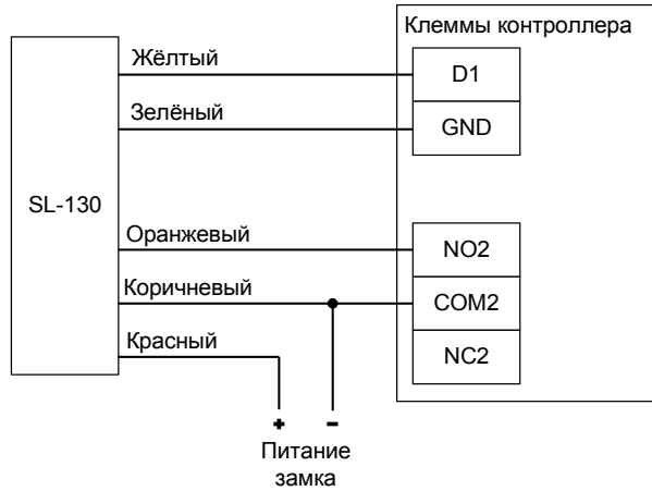
Рисунок 24. Пример подключения замка SL-130 для первой двери.
