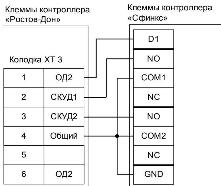
Рисунок 72. Подключение турникетов и калиток «Ростов–Дон», старая электроника, вариант №2.
