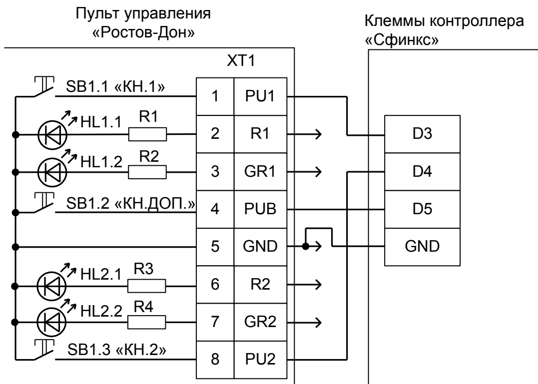
Рисунок 75. Подключение пульта управления Ростов–Дон, старая электроника.
