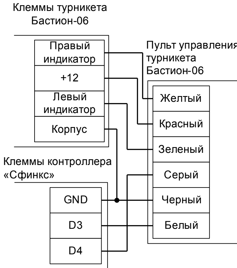
Рисунок 78. Первый вариант подключения пульта управления турникетами «Бастион-06» и «Бизон».
