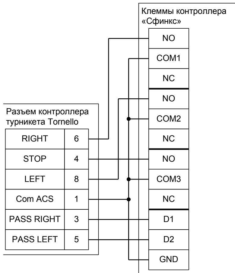
Рисунок 88. Подключение турникетов Tornello.
