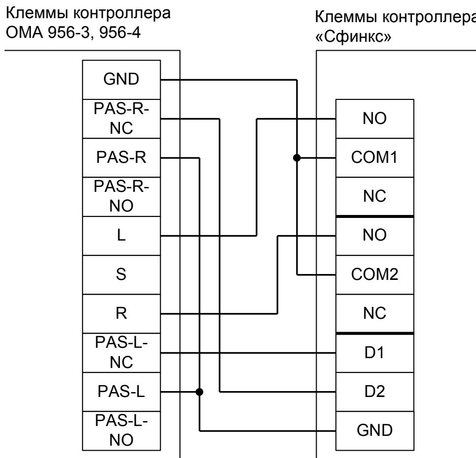
Рисунок 62. Подключение турникета ОМА с контроллером ОМА 956-3, 956-4.
