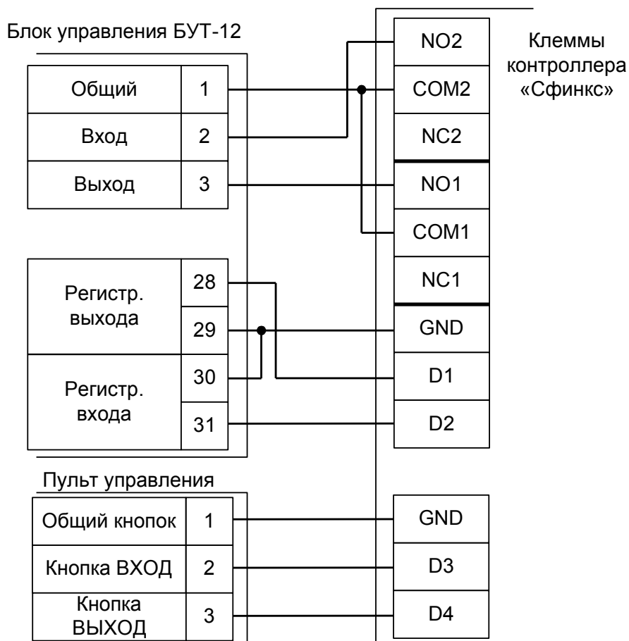
Рисунок 80. Подключение турникетов «Форма».
