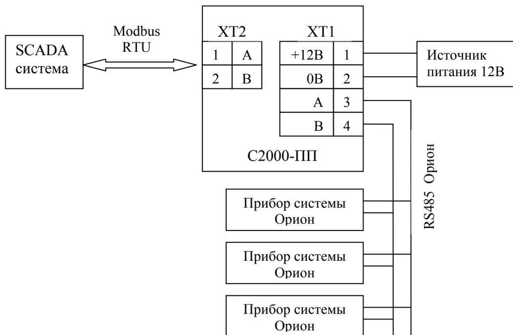
Рис. 10. Подключение С2000-ПП в режиме «Орион-Master»
