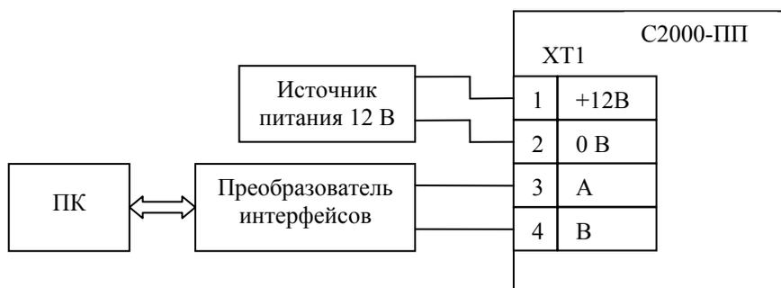
Рис.8. Схема для конфигурирования С2000-ПП
