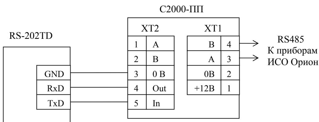
Рис. 12. Подключение передатчика к C2000-ППУ
