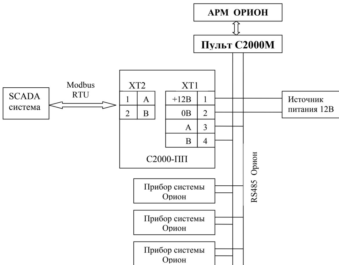
Рис. 11. Подключение C2000-ППУ в режиме «Орион-Slave»
