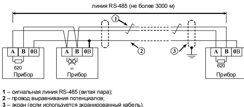
Рис. 12. Схема подключения приборов к магистральному интерфейсу RS-485
