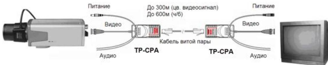
Рис.2 Схема подключения TP-CPA
