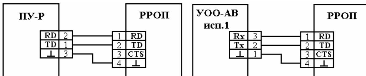
Рис. 33. Подключение РРОП к системным устройствам на примере ПУ-Р и УОО-АВ исп.1
