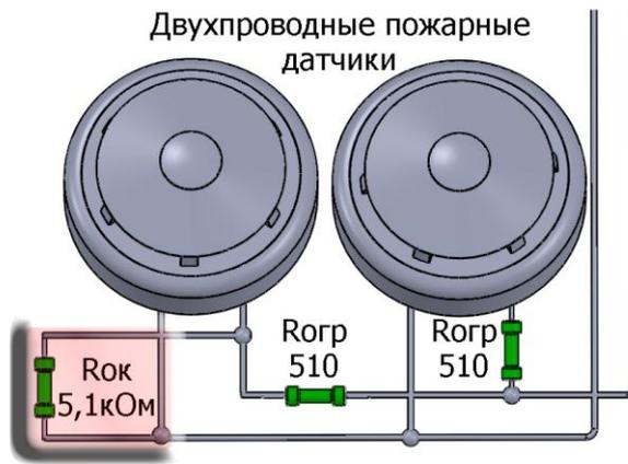
Для точной настройки уровней рекомендуется производить срабатывание извещателей по одному в шлейфе, каждый раз при этом сбрасывая питание. Затем требуется произвести попарное срабатывание извещателей в различных комбинациях, также сбрасывая каждый раз питание.
