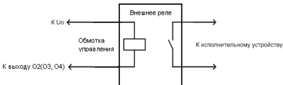
Рис. 24. Схема подключения внешнего реле к выходам устройства O2, O3, O4 (выходы типа «открытый сток»)
