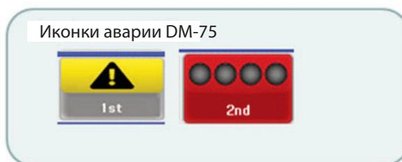
Двойное нажатие курсором мыши на какую-либо иконку DM-75 автоматически переводит пользователя на вкладку **Equipment**, где можно просмотреть более подробную информацию о каждом модуле.
