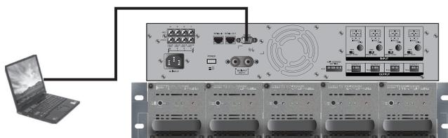
Усилители можно объединить в сеть на основе интерфейса RS-422. Соединение усилителей выполняется последовательно — выход одного устройства со входом следующего. Максимальное расстояние между оконечными устройствами сети составляет 1 км.
