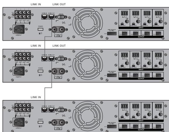
Каждому блоку DPA-5075M при помощи переключателей, расположенных на задней панели, необходимо присвоить индивидуальный сетевой адрес. Восемь переключателей соответствуют восьми разрядам двоичного числа. При верхнем положении переключателя значение разряда равно 1, при нижнем положении переключателя значение разряда равно 0.
