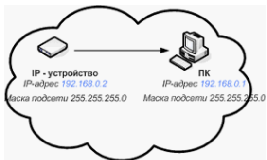
Рис. 6.1—15 Сервер и IP-камера находятся в одной подсети
