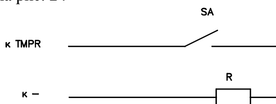
Рис. 24 Схема подключения тампера
