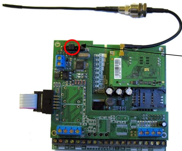
Перемычка «А» находится на верхней плате в виде уголка вверху слева относительно клемной колодки.
