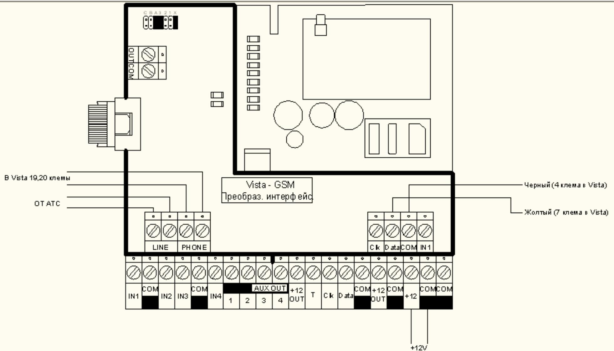
Схема подключения модуля связи GSM-Vista к контрольной панели Vista 50Plr, Виста-501В:
