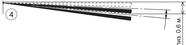
Двигайте линзу для выбора угла детекции (0-3 градуса) как показано на рисунке и проверьте, чтобы линза была не закреплена замками линзодержателя.
