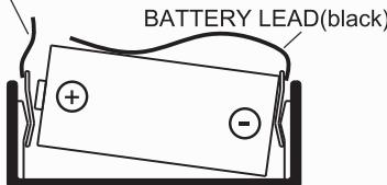
Для правильной работы извещателя используйте специальные провода для батареи. Установите клеммы между отсеком и батареей и зафиксируйте батарею. Подключайте провода перед подачей питания. Соблюдайте полярность.
