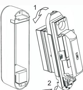
Проведите проводку через отверстие базы к задней крышке и подсоедините ее к клеммам. Используйте губку для защиты от попадания грязи и влаги внутрь корпуса.
