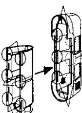
После регулировки угла наклона вставьте обратно линзодержатель внутрь передней крышки. Замки А, В и С линзодержателя должны войти в пазы передней крышки "A", "B" и "C".
