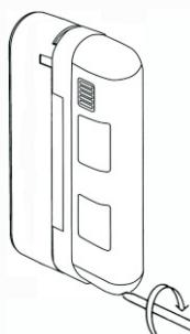
Установите базу на монтажную плату. Закрепите базу двумя винтами.
