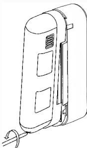
Ослабьте крепежный винт передней крышки и снимите переднюю крышку. Не касайтесь поверхности линз.
