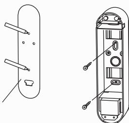
Проведите проводку через специальное отверстие и закрепите монтажную плату на стене, используя 2 винта (входят в комплект). Высота установки должна находиться в пределах 0,8 - 1,2 м.
