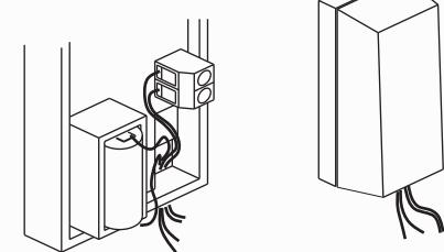
Используйте сигнальный кабель для подключения питания и закройте крышку.
