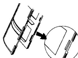
Двигайте линзу для выбора угла детекции (0-3 градуса) как показано на рисунке и проверьте, чтобы линза была не закреплена замками линзодержателя.
