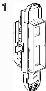
Снимите отсек для установки батареи с основания извещателя
