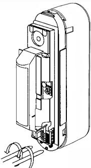
Ослабьте винты для крепежа монтажной основы. Не касайтесь отражателя
