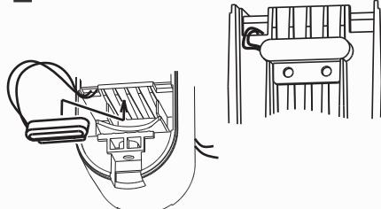
Магнитоконтакт с проводами должен быть закреплен на обратной стороне задней крышки.
