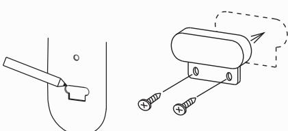
Используйте специальное отверстие для установки тампера на стену.
