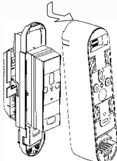
Снимите заднюю крышку, предварительно опустив ее вниз
