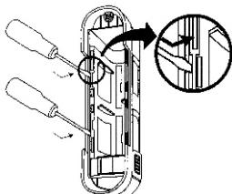
Откройте 3 замка с двух сторон линзодержателя про помоши лезвия ножа или отвертки (см. рис.). Затем выньте линзодержатель с передней крышки, удерживая замки линзодержателя.
