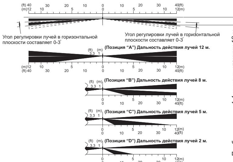
Регулировка лучей в горизонтальной и вертикальной плоскости осуществляется независимо для обоих сторон (см. Сек 7 "Настройка диапазона детекции")
