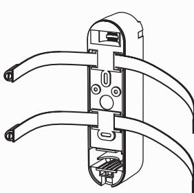
Используйте металлические ленты для закрепления извещателя на столб. Размеры металлической (высота 20мм./толщина 0,5 мм.)
