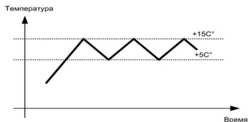
Рис. 3. Характеристика термореле
