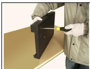
4. закрутите винты жесткого диска
