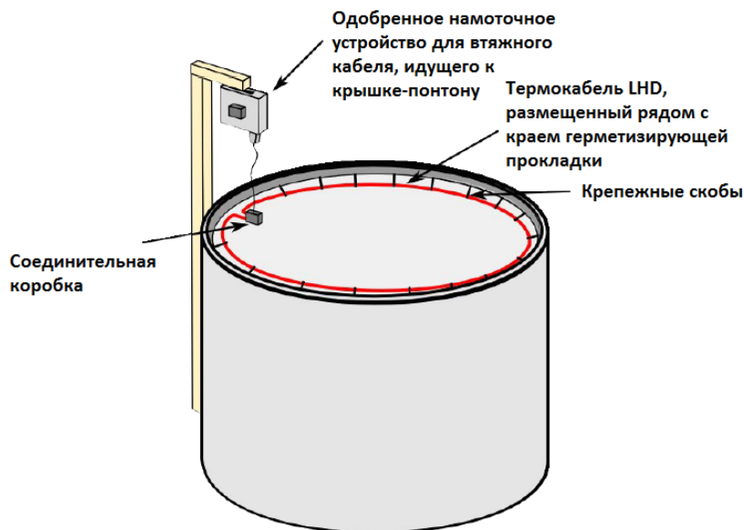
Изображение 10: Стандартные места размещения Термокабеля LHD в резервуарах с понтонами
