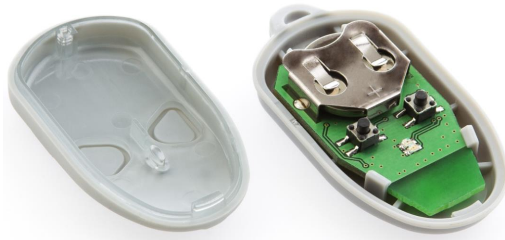
Рисунок 2. Идентификатор со снятой крышкой. Видна батарея питания
