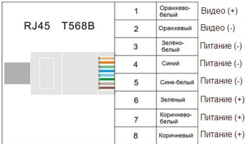
Рис.5 Распиновка разъемов RJ45
