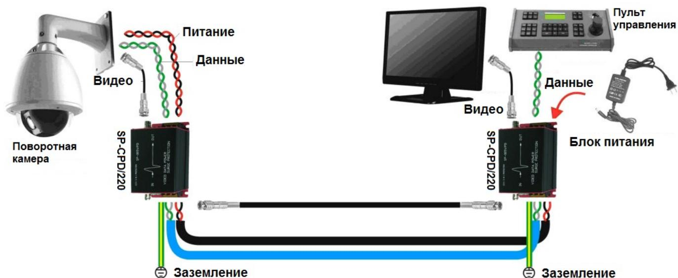
Рис. 3 Подключение SP-CPD/220
