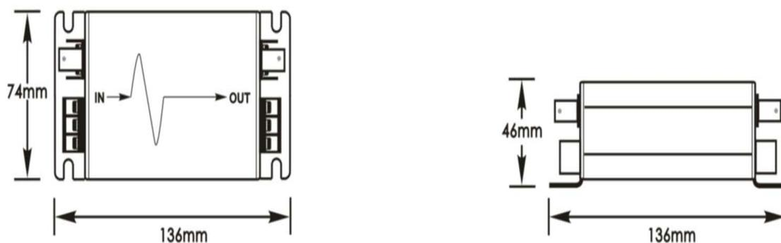
Рис. 2 Габаритные размеры SP-CPD/220
