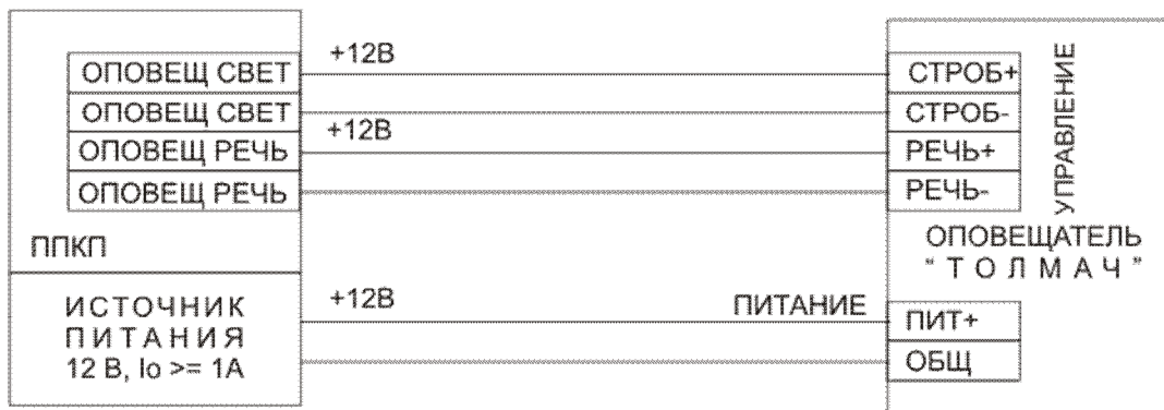
Рис. 1. Типовая схема подключения оповещателя "Толмач"
