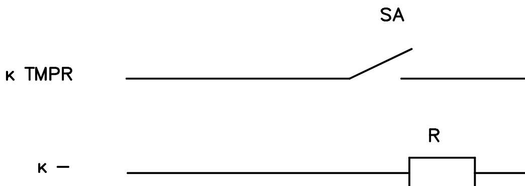
Рисунок 24 - Схема подключения тампера
