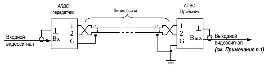
Рис.3 Схема включения АПВС-5 АНД при невозможности заземления на передающей стороне
