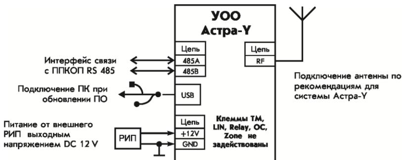
**Обращаем ваше внимание**, что режимы работы, устанавливаемые переключателями, активируются в момент подачи питания. Поэтому переключатели нужно снимать с вилок и устанавливать на вилки при **отключенном питании** приборов, если нет особого указания в сопровождающих руководствах по эксплуатации.
