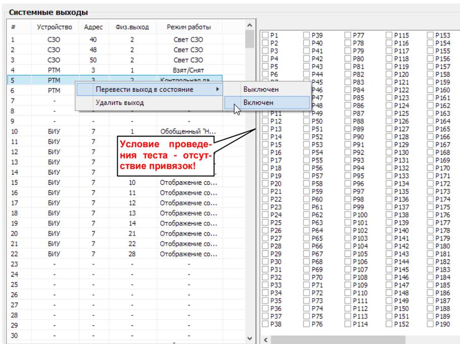
3) Проверить соответствие состояния выхода выбранному режиму визуально (для оповещателей СЗО или ОПС) или с помощью тестера.
