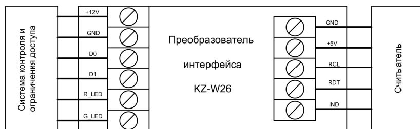
Рисунок 1. Схема подключения преобразователя интерфейсов
