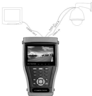
Рис 3.2.2-1 Подключение тестера к аналоговой камере.
