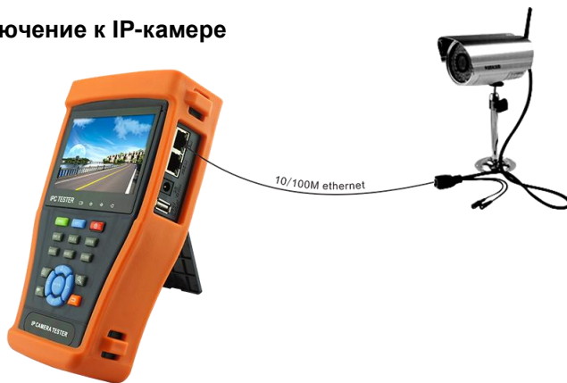
Рис 3.2.1-1. Подключение тестера к IP-камере.
