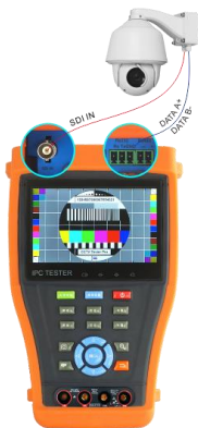
Рис 3.2.3-1 Подключение тестера к аналоговой камере высокого разрешения.
