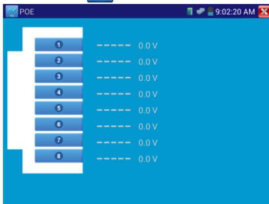
Рис. 3.3.18-1 Напряжение PoE на линиях кабеля витой пары
