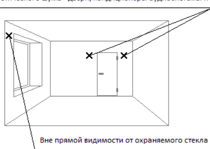
Рис.3 Запрещенные места установки
