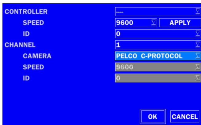
Рисунок 3.4.1.1. Настройка экрана контроллера и PTZ
