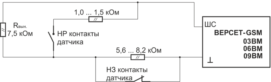
Рис.7. Схема включения технологических датчиков в ШСТ.
