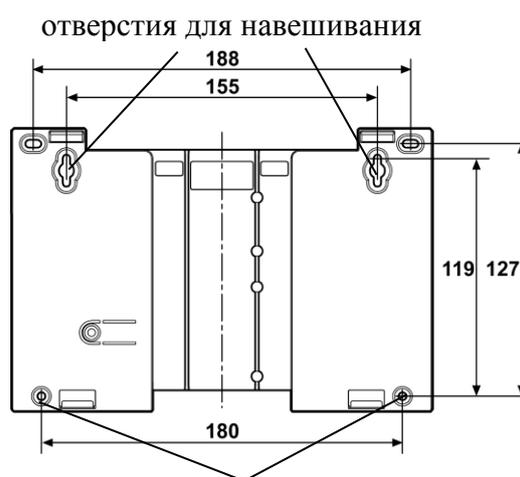
отверстия для дополнительных шурупов
