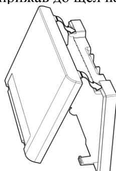
2. Навесьте основание на предварительно вкрученные в стену шурупы и закрепите его дополнительными шурупами
