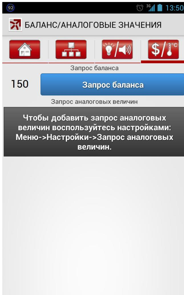
Вкладка предназначена для контроля баланса SIM-карты РРОП-GSM, а так же для запроса и отображения аналоговых величин (различных значений) с извещателей (температура, уровень дыма и т.д.).
