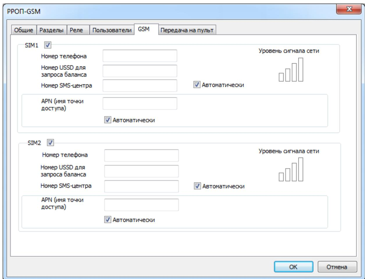
На этой вкладке устанавливаются параметры для SIM-карт, установленных в РРОП-GSM
