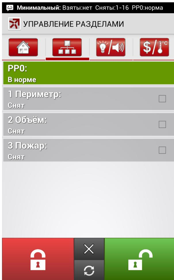
Вкладка предназначена для отображения состояния и управления системой. По умолчанию преднастроено отображение для квартирного комплекта Sagittarius 2 SIM:
