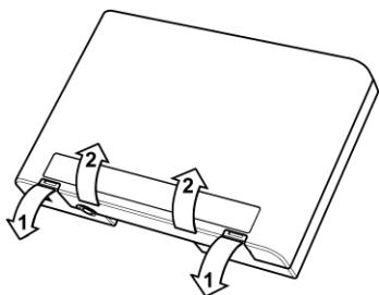
3. Закройте корпус, зацепив крышку за основание и плотно прижав до щелчка
