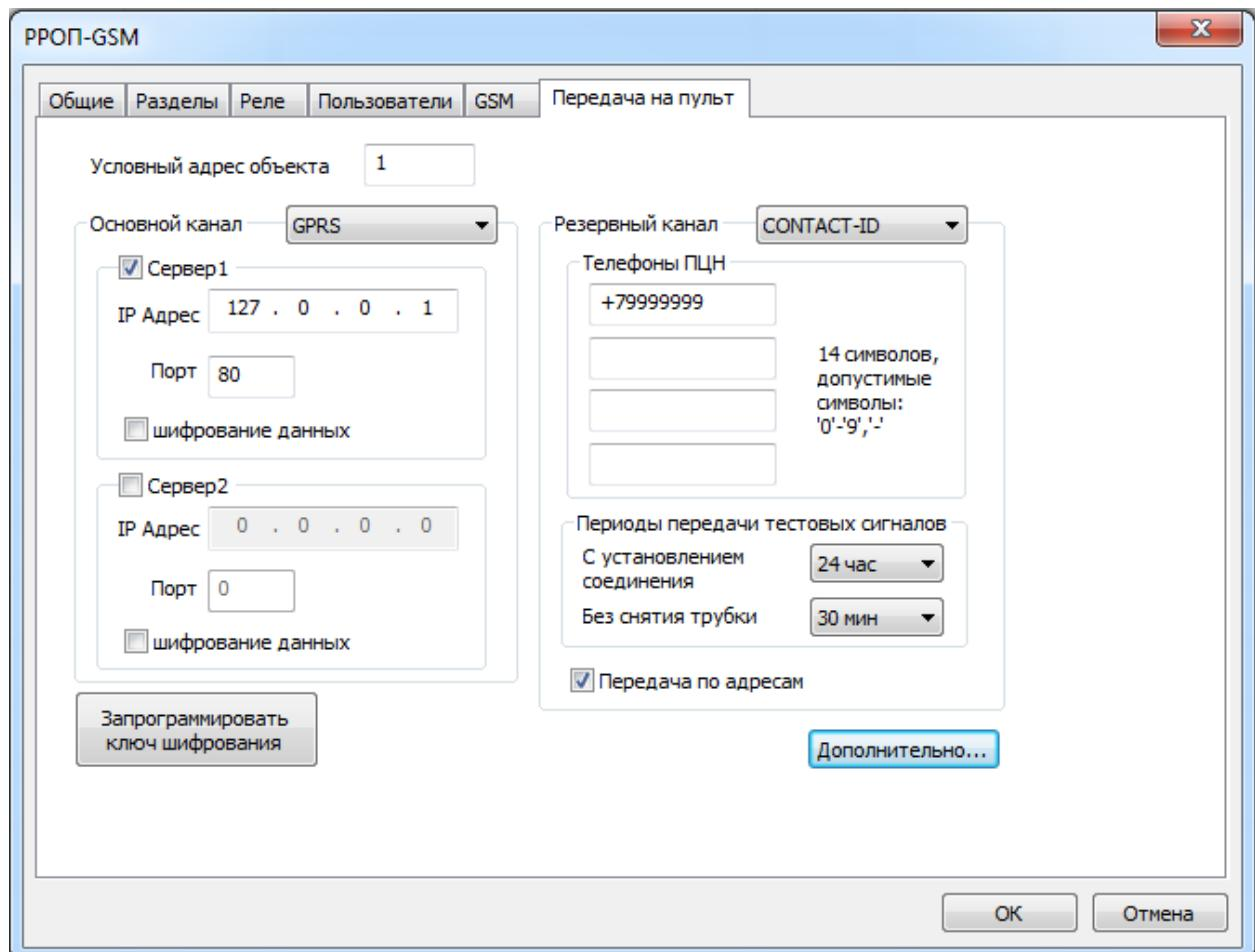
На этой вкладке определяются каналы передачи на пульты централизованного наблюдения
