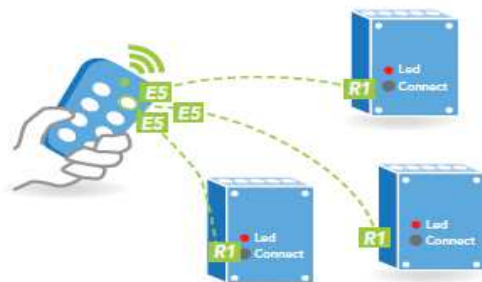
А-1б Подключение передатчика к 3 приемникам
