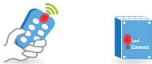
А-2а Светодиоды мигают, когда приемник получает команды от передатчика
