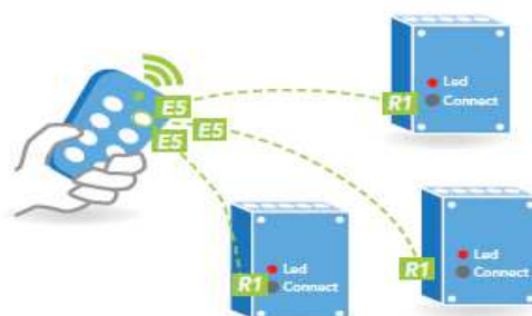
А-1b Подключение передатчика к 3 приемникам
