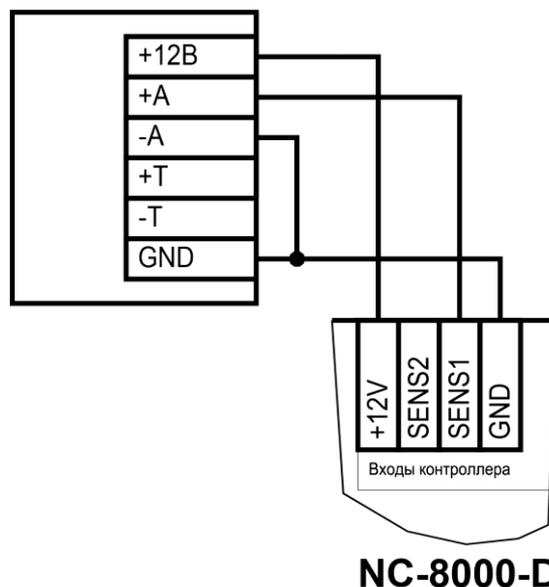
Рисунок 16. Схема подключения охранного датчика без контроля состояния линии
