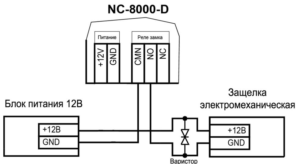
Рисунок 8. Схема подключения отпираемой напряжением защелки
