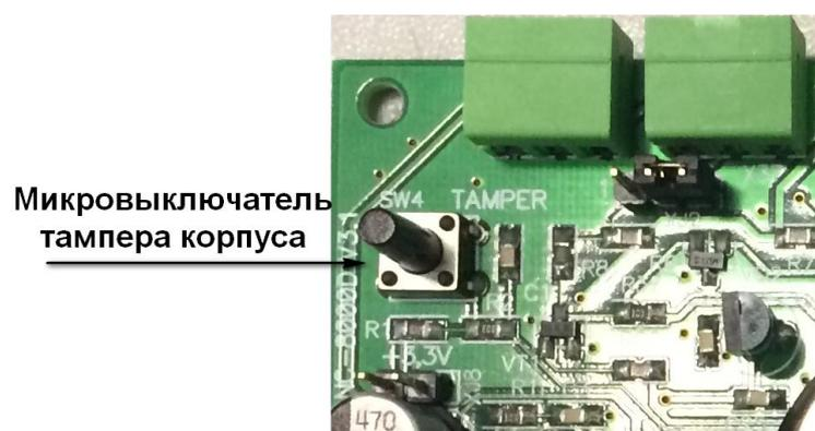
Рисунок 18. Подключение тампера корпуса
