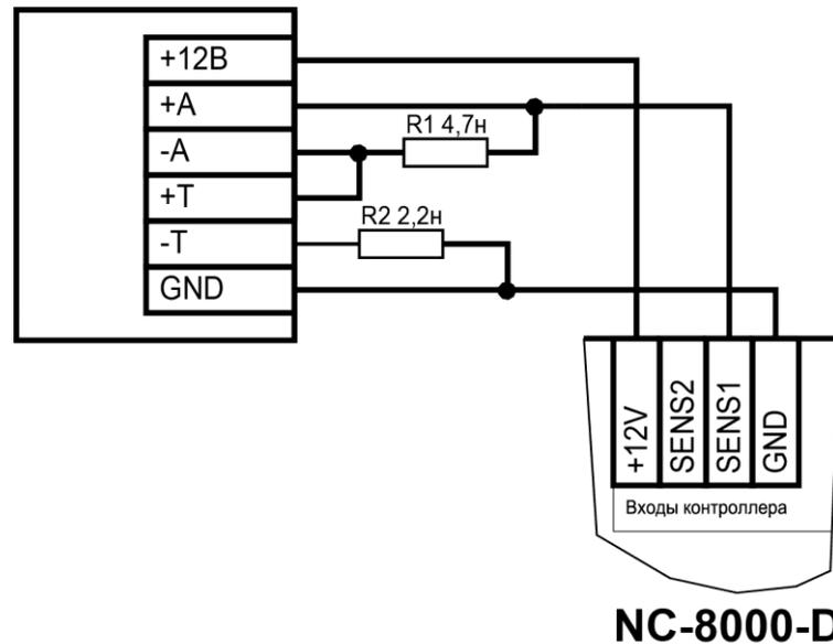
Рисунок 15. Схема подключения охранного датчика с контролем состояния линии
