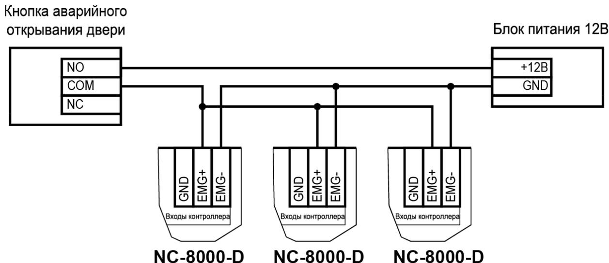
Рисунок 20. Схема подключения одной аварийной кнопки к нескольким контроллерам
