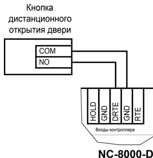
Рисунок 13. Схема подключения кнопки дистанционного открывания двери
