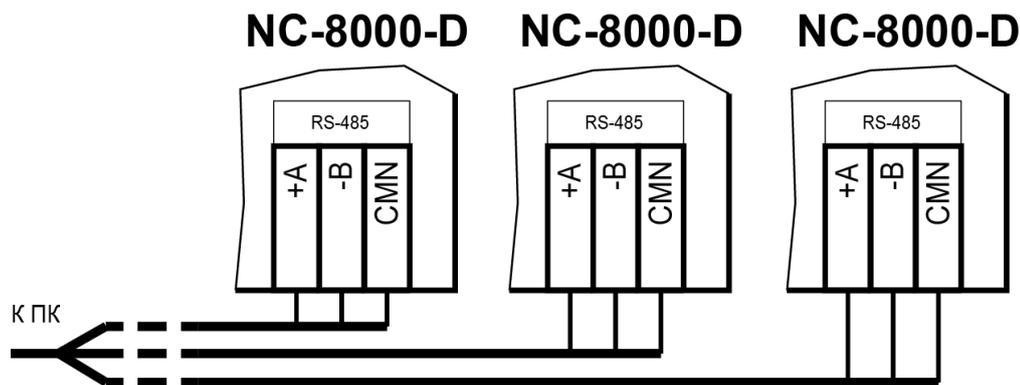
Рисунок 22. Пример соединения контроллеров по топологии «Звезда»
