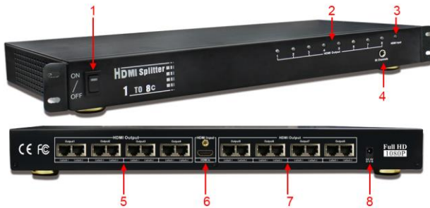
Рис.3 Элементы разветвителя D-Hi104T/D-Hi108T
