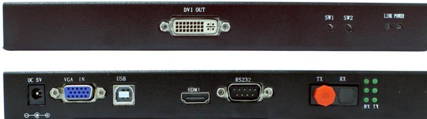
Рис.2 Передатчик SFH14S5T, вид спереди/сзади
